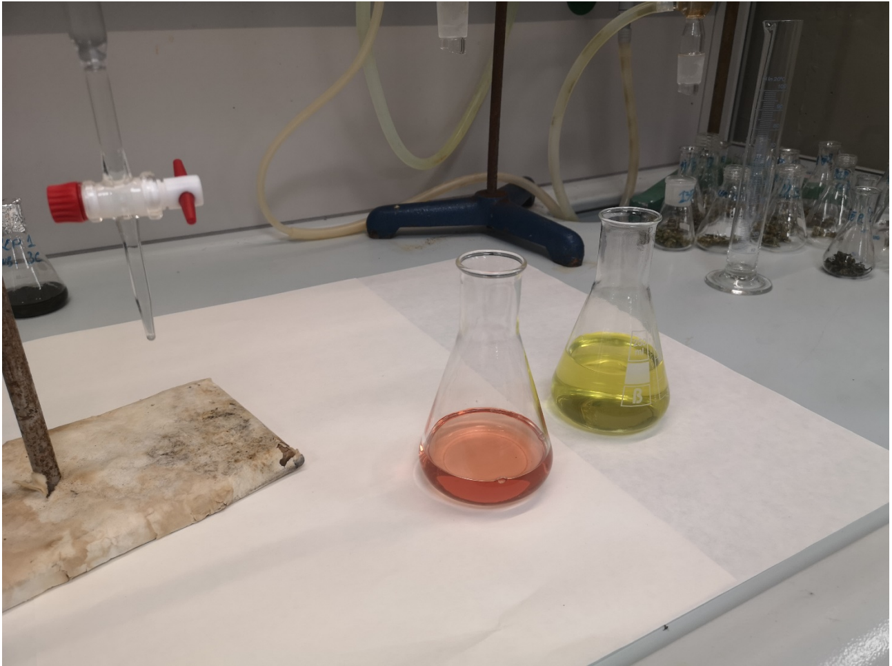
Fig 4. Versare il contenuto della beuta a collo grande in beuta a collo piccolo con olio dentro e leggere il volume della buretta. Solo dopo, aggiungere volumi (leggibili per differenza) dalla beuta sino al viraggio al colore della beuta di sinistra (rosso mattone) ben diverso dal colore di destra di un qualsiasi olio non titolato
