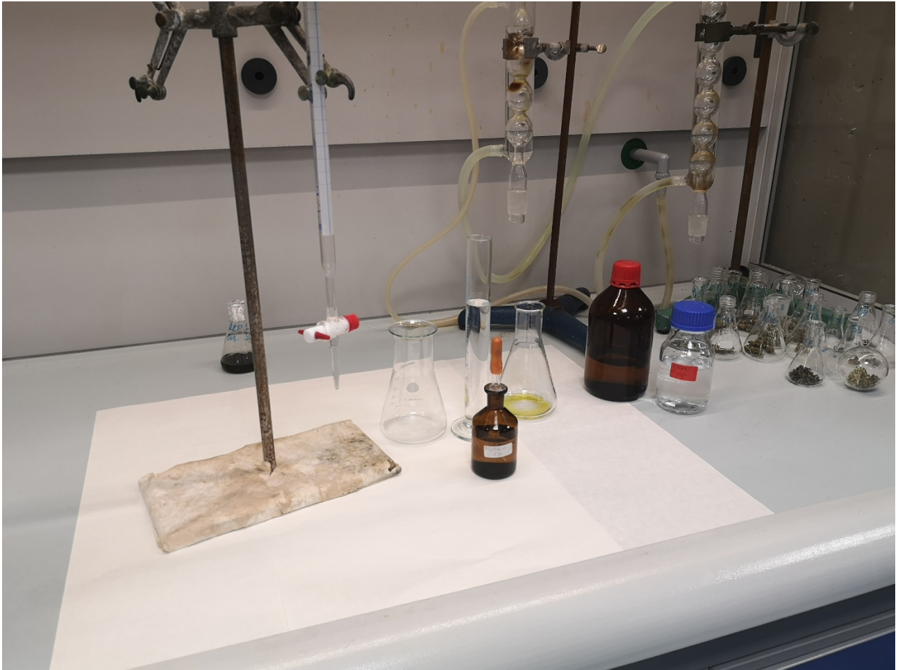
Fig.1 Occorrente da sinistra a destra :Buretta (con NaOH 0,1N), due beute di cui una in cui si pesa olio d'oliva (circa 5g), cilindro graduato per misurare 30 mL di EtOH e 60ML di etere dietilico (totale 90 mL)
