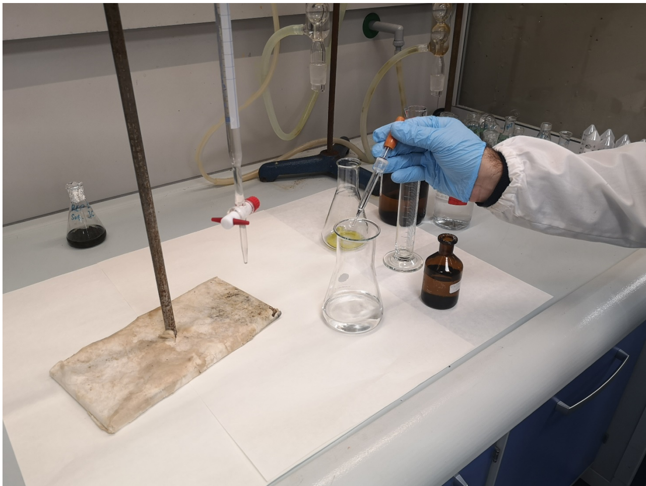
Fig. 3 Piazzare due gocce di indicatore fenolftaleina (incolore); successivamente si mette qualche goccia di NaOH dalla buretta sino a colorazione rosa pallido della soluzione (eliminazione dell'acidità residua dei solventi etere e etanolo)
